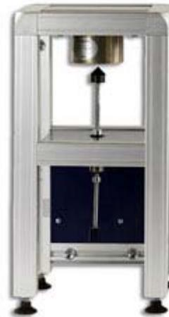
Balancierung eines Stabes durch Steuerung von Magneten
