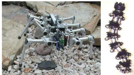
**Abbildung 3.** Beispiele für Spezialbauformen zur besseren Adaptation an die Umwelt. Einsatz im Freien mit dem Ziel der Minenräumung bzw. der Kanalinspektion (beide Fraunhofer-AiS).
