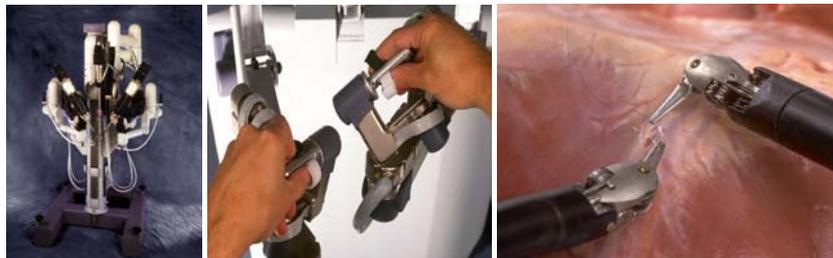
**Abbildung 11.** (a) Operationsroboter *daVinci* von *IntuitiveSurgical* (*Intuitive* 2003) b) Bediengeräte für die beiden Roboterarme (c) Knotenvorgang
