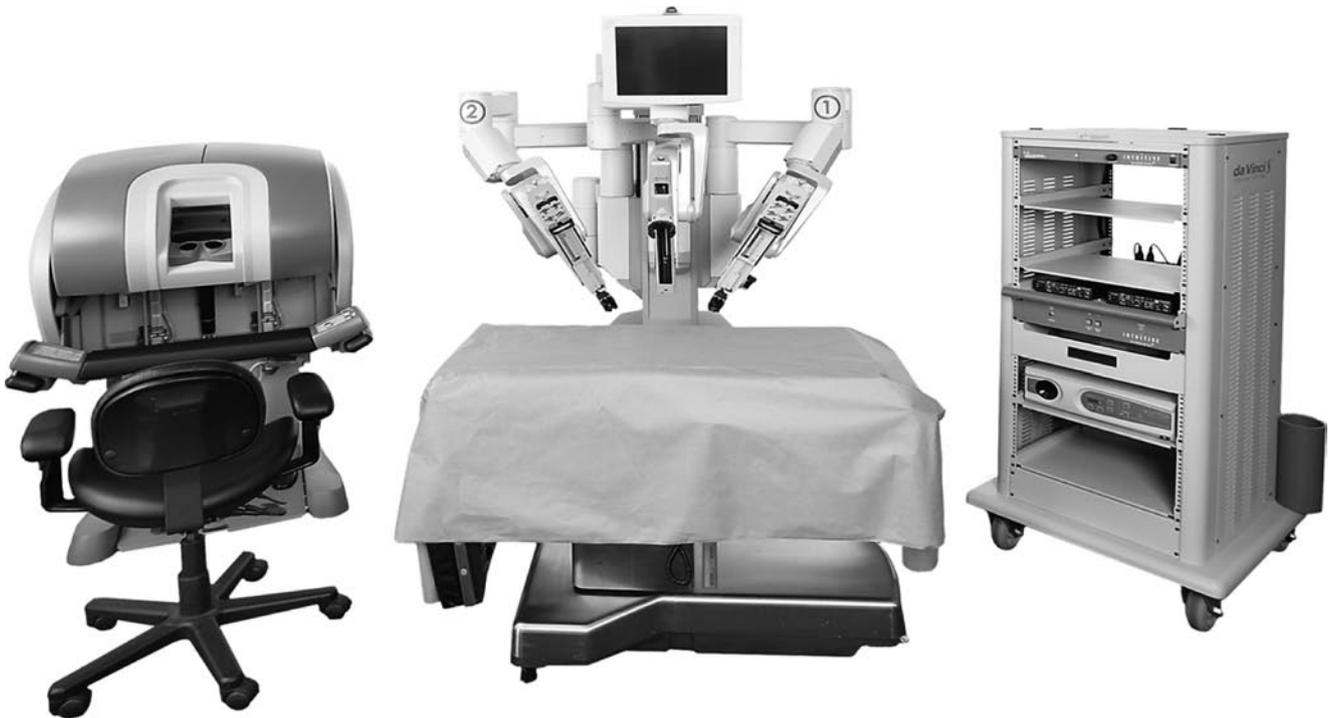
**Abb. 1** ▲ Das Master-Slave-System DaVinci: **a** Bedienkonsole; **b** Slave-Element am Patienten; **c** Turm mit Peripheriegeräten
