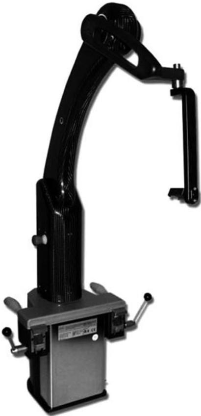
**Abb. 5** ▲ Kameraführungssystem der 2. Generation: SoloAssist: Das Leichtbaugerät kann problemlos von einer Assistenzperson montiert/demontiert werden. Es werden nur fluidische Antriebe verwendet, sodass keine störenden elektromagnetischen Felder aufgebaut werden. Die intraoperative Fluoroskopie ist möglich
